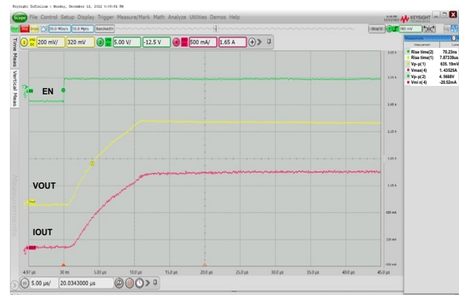
Enable power on: Iout=1.5A
